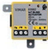
03982 Cosφ 0,6 2 A 100-240 V~ 50/60 Hz motor için değişim rölesi çıkışı çita yönlendirmeli 1 panjur için, uzaktan kumanda, mesh View Wireless ve Zigbee 3.0 sistemi için Bluetooth® wireless technology 5.0, gömme kurulum (güçlendirici) donanımlı kumanda cihazı
