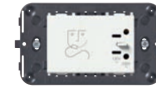
09290 230 V~ 50/60 Hz, izolasyon transformatörlü 20 VA, 230 V~ / 120 V~ çıkışlar - 3 modüllü. Derinlik: 42 mm
