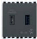
▲20295.AC 5 V 3 A, toplam olarak 3 A, 120-240 V~ 50/60 Hz akım sağlayan 2 USB-A+C çıkışı - 2 modüllü. Derinlik: 29 mm
