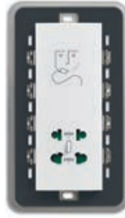
20291.B 6 230 V~ 50/60 Hz, izolasyon transformatörlü 20 VA, 230 V~ / 120 V~ çıkışlar. Derinlik: 41 mm
