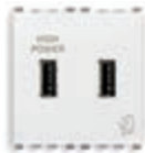
20295.B 5 V 2,1 A, toplam olarak 2,1 A, 120-230 V~ 50/60 Hz akım sağlayan 2 USB-A çıkışı - 2 modüllü. Derinlik: 37 mm
