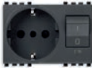
20276 16 A P30 250 V~, 1P+N C 16 - 3 modüllü. Derinlik: 39,8 mm
