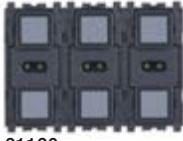
21126 6 bağımsız tuş, 8 polarize olmayan giriş, 7 polarize olmayan kontak katı durum çıkışları, 9-32 Vdc besleme - 3 modüllü. Derinlik: 22,8 mm
