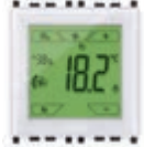
02952.B 2 bağımsız alanın bulunduğu ortamda sıcaklık kontrolü için elektronik termostat, KNX standardı, 1 adet NO 4 A 24 V~ röle çıkışı, sıcaklık sensörü için 1 adet giriş, 1 adet programlanabilir dijital giriş - 2 modüllü. İlgili 16723.B destek ile monte ediniz. Derinlik: 38,5 mm
