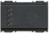
16927 Oda dışına kurulum için transponder kart okuyucu, standart KNX, 2 relé çıkışlı NO 4 A 24 V~, 2 giriş, 12-24 V~ 50/60 Hz ve 12-24 Vdc (SELV) - 3 modüllü. Transponder kartsız tedarik edilir. Derinlik: 36,5 mm
