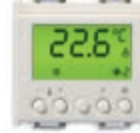
16915.B Isıtma ve soğutma olmak üzere 2 bağımsız alanın sıcaklık kontrolü için termostat standart KNX, çıkış rölesi NO 4 A 24 V~ + 1 sıcaklık sensörü girişi + 1 programlanabilir giriş - 2 modüllü. Derinlik: 36,5 mm
