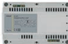
01401 Besleme ünitesi, 29 Vdc, 1280 mA, 120-230 V~ 50/60 Hz, 8 modüllü x 17,5 mm
