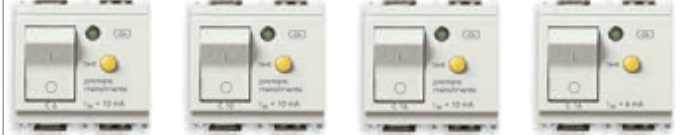
16511.06.B C 6, I_{\Delta n} 10 mA, kesme kapasitesi 1500 A - 2 modüllü, Derinlik: 38 mm 16511.10.B C 10, I_{\Delta n} 10 mA, kesme kapasitesi 3000 A - 2 modüllü, Derinlik: 38 mm 16511.16.B C 16, I_{\Delta n} 10 mA, kesme kapasitesi 3000 A - 2 modüllü, Derinlik: 38 mm 16511.16.6.B C 16, I_{\Delta n} 6 mA, kesme kapasitesi 3000 A - 2 modüllü, Derinlik: 38 mm
