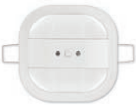
01527 ON/OFF (AÇMA/KAPATMA) açma ve parlaklık ve/veya harekete duyarlı aydınlatma, ısıtma, iklimlendirme, havalandırmanın sürekli ayarlanması için 360° kızılötesi varlık tespit sensörlü dedektör, ayarlanabilir parlaklık alanı 1-1000 Lux, KNX standardı, tavana kurulum. Boyutlar: 80x80x45 mm
