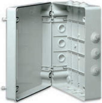
V55110 IP55, izolasyon malzemesinden vidalı kapak, gri RAL 7035. Çiftli menteşe ile tedarik edilir
