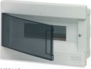
V52412 12 modül, DIN raylı (60715 TH35), beyaz RAL 9003, duman rengi kapaklı. Harcanan güç: 28 W
