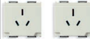
16261.B SICURY 2P+E 10 A, Avustralyalı - 2 modüllü. Derinlik: 26,5 mm 16262.B SICURY 2P+E 15 A, Avustralyalı - 2 modüllü. Derinlik: 26,5 mm
