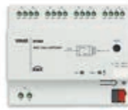
01544 KNX DALI geçidi, kanal başına 16 lambalı 8 kanal, 6 modüllü x 17,5 mm
