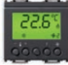
16915 Isıtma ve soğutma olmak üzere 2 bağımsız alanın sıcaklık kontrolü için termostat standart KNX, çıkış rölesi NO 4 A 24 V~ + 1 sıcaklık sensörü girişi + 1 programlanabilir giriş - 2 modüllü. Derinlik: 36,5 mm
