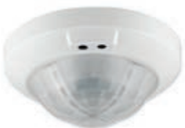
01529 Parlaklık fonksiyonunda lambaların açılması için 360° hareket menzili olan kızılötesi dedektör, 0 -1000 Lux, KNX standardı, tavana kurulum
