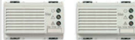
16591.B Gas Stop GPL, LPG gaz sızıntısı detektörü, solenoid valf kontrolü, 230 V~ - 3 modüllü, Derinlik: 42,5 mm 16592.B Gas Stop Metano, metan gazı sızıntısı detektörü, solenoid valf kontrolü, 230 V~ - 3 modüllü, Derinlik: 42,5 mm
