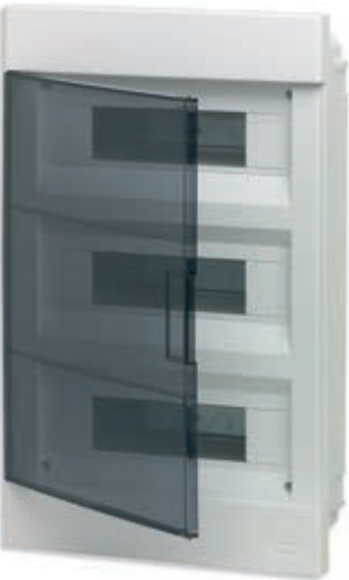
V52436 36 modül, DIN raylı (60715 TH35), beyaz RAL 9003, duman rengi kapaklı. Harcanan güç: 68 W
