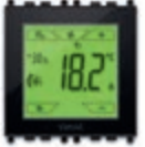
02952 2 bağımsız alanın bulunduğu ortamda sıcaklık kontrolü için elektronik termostat, KNX standardı, 1 adet NO 4 A 24 V~ röle çıkışı, sıcaklık sensörü için 1 adet giriş, 1 adet programlanabilir dijital giriş - 2 modüllü. İlgili 16723 destek ile monte ediniz. Derinlik: 38,5 mm
