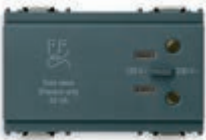
16290 230 V~ 50/60 Hz, 20 VA izolasyon transformatörlü, çıkış gerilimi 230 V~ ve 120 V~ - 3 modüllü. Derinlik: 46 mm
