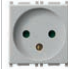
14240.SL SICURY 2P+T 16 A, İsrail standardı - 2 modüllü. Derinlik: 28,7 mm
