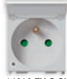
14212.FX.C.SL SICURY 2P+E 16 A, Fransız, kapaklı - 2 modüllü. Derinlik: 29,9 mm
