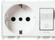
14276 16 A P30, 1P+N C 16 - 3 modüllü. Derinlik: 38,8 mm
