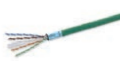
03076 Kablo Kat. 6 F/UTP, korumalı, 4 çift, 23 AWG, LSZH kıyılı, CPR Eca Sınıfı, I. Kategori kablolar ile montaj için uygun (U0 = 400 V), zelena - 500 m
