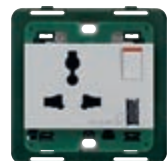
■ 14266.A.SL SICURY 2P+E 13 A 250 V~ 2P anahtarlı ve USB tip A çıkışlı multistandart. Derinlik: 21 mm
