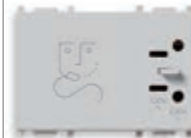
14290.SL 230 V~ 50/60 Hz, izolasyon transformatörü 20 VA, 230 V~ / 120 V~ çıkışlar - 3 modüllü. Derinlik: 41 mm
