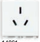
14261 SICURY 2P+E 10 A, Avustralya - 2 modüllü. Derinlik: 28,2 mm
