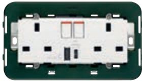
■ 14224.AC SICURY 2P+E 13 A 250 V~, iki adet 2P anahtarlı, bir USB tip A çıkışlı ve bir USB tip C çıkışlı. Derinlik: 21 mm
