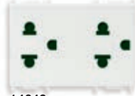
14249 İkili SICURY 2P+E 16 A, Avro-Amerikan - 3 modüllü. Derinlik: 23,5 mm
